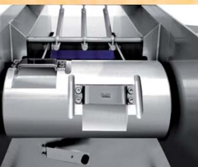
Die Schneiddicke der Messer kann ihren Wünschen, ihren technischen und technologischen Anforderungen entsprechend eingestellt werden. Dabei kann der STARCUTTER 312/314/318 zwischen 3 und 9 mm, der STARCUTTER 344/348 zwischen 14 und 20 mm und der Starcutter 378 zwischen 39 und 45 mm Schneiddicke justiert werden.
