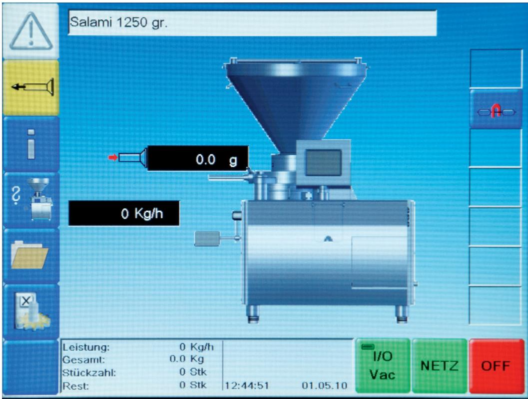
La commande de pousoir ultime avec de multiples possibilités, consiste en un PC industriel et un écran tactile sur l'avant du pousoir.
